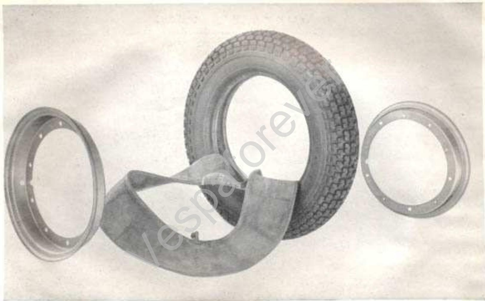
Fig. 18 - Smontaggio pneumatici
